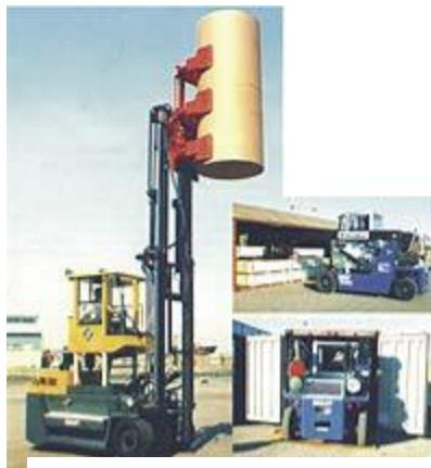
**Рис.1.** Погрузчики "Meclift" с подъемной кабиной
