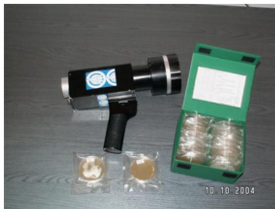
Рис.1 Оборудование, используемое для отбора микробиологических проб воздуха МКС
