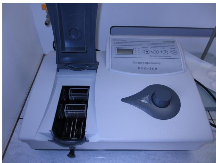
**Рис.4.** Спектрофотометр КФК-ЗКМ
