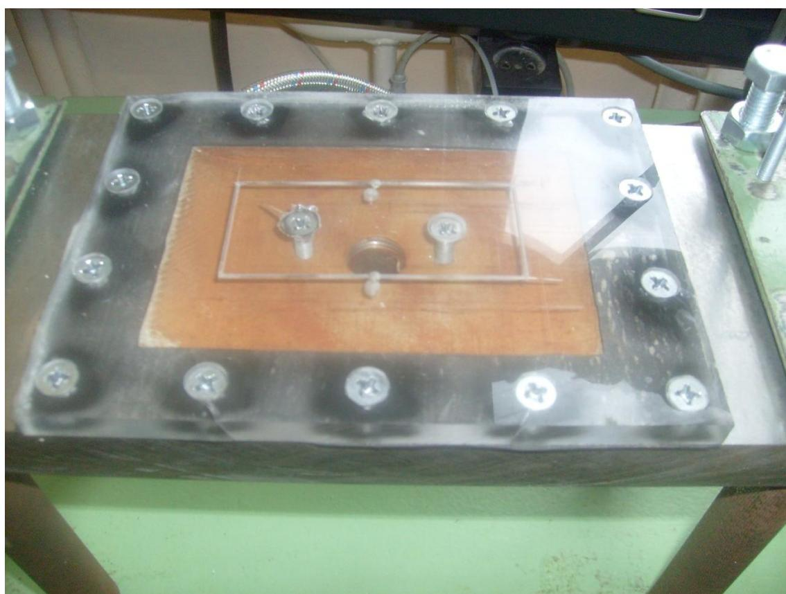
Рис. 2. Рабочая поверхность направляющей.
