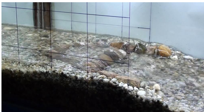
Fig. 9. A – rock weir (Discharge Q = 2,5 \text{ l} \cdot \text{s}^{-1} ( 0,791 \text{ m}^3 \cdot \text{s}^{-1} ))
