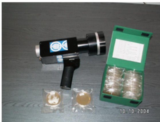
Рис.1 Оборудование, используемое для отбора микробиологических проб воздуха МКС
