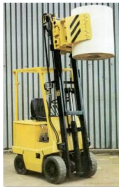
Рис.4. Погрузчик с быстросъемными грузозахватными приспособлениями
