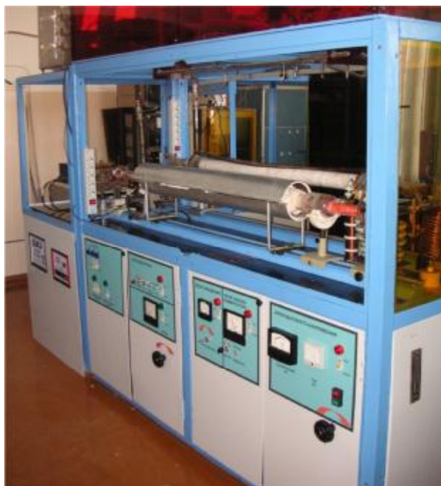
Рис. 5. Внешний вид исследовательской лазерной установки для резонансной абляции материалов и биотканей.
