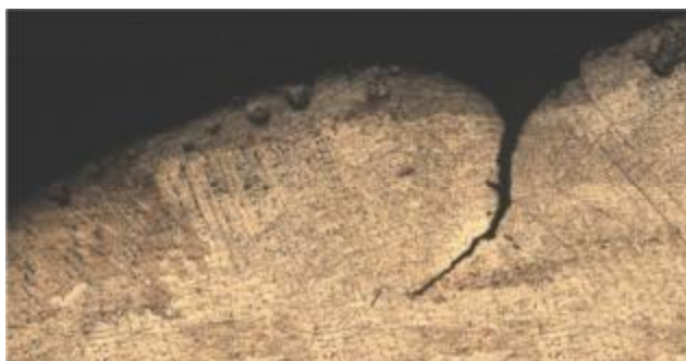
Fig.5. Микроструктура сварного шва с трещиной при \times 100
