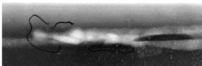
Fig.4. Рентгенограмма сварного шва с трещинами
