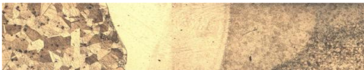
Fig.6. Панорамное изображение образца с фланцем повышенной жесткости с трещиной ( \times 100 )
